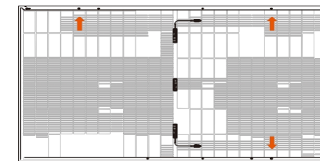
Vnější čtyřtvarové šroubové uchycení, nosník kolmý k e krátkému rámu
