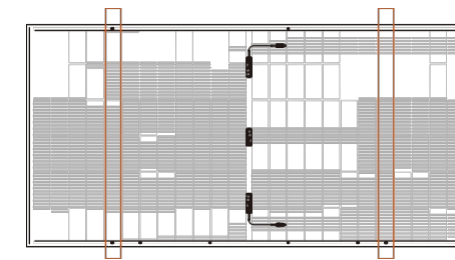
Vnější čtyřtvarové upevnění šroubů, nosník kolmý k dlouhému rámu.
